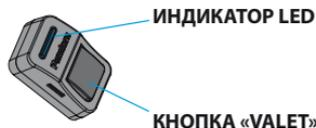
Если система была снята с охраны и выключено зажигание, то после ввода «Сервисного ПИН-кода» система перейдет в режим программирования. Выход из режима программирования осуществляется путём включения зажигания. Для аварийного включения режима охраны при выключенном зажигании нажмите и удерживайте кнопку **«VALET»** в течение 3 сек. Через 30 сек. система будет взята под охрану. В период отсчета времени статусный индикатор системы горит красным цветом.
